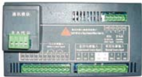
B型控制器通信模块端子
