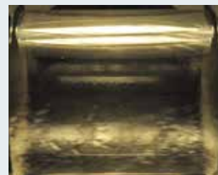
90% 蒸汽干度( x = 0.9 ) 10% 冷凝水(脉动流)
