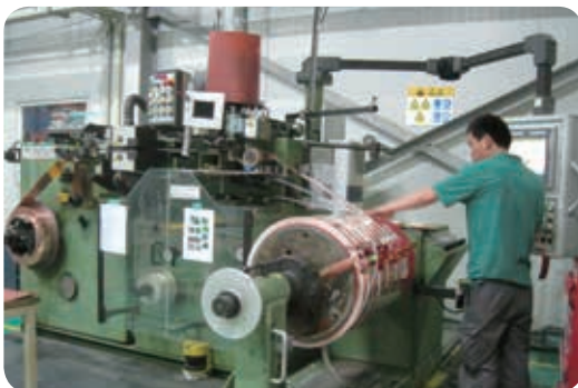
带状铜导体绕制高压线圈
