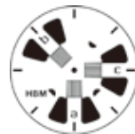
0^\circ/45^\circ/90^\circ 应变花 如 RY3x
