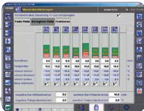
集成于注塑机控制的操作设备(ENGEL)
