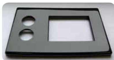
采用动态调温后无熔接痕
