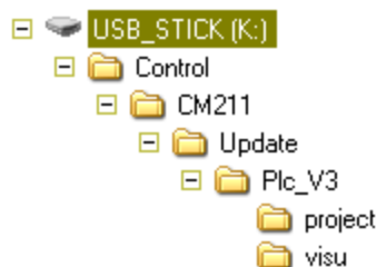
Bild: Inhalt des Update-USB-Sticks mit einer CODESYS-V3-Applikation
