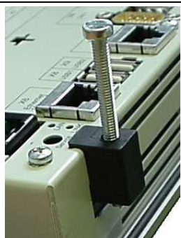
Abbildung 2: Symbolische Abbildung Klemmblock für die Befestigung
