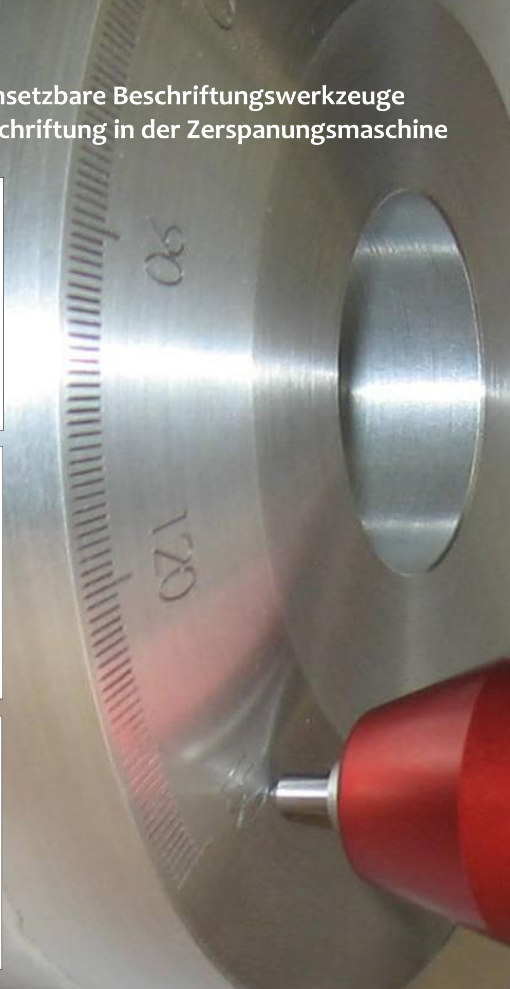
Mantelflächen-Beschriftung auf Drehautomat
