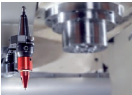
Automatische Einwechslung über Werkzeugwechsler
