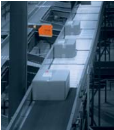
可扩大传感范围使得传感器能够被放置在离目标更远的地方。
