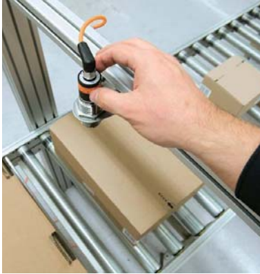
OID开关点可通过旋转设定环轻松设置（易旋转）。标尺可显示所设置的距离。因而开关点可在安装之前设置
