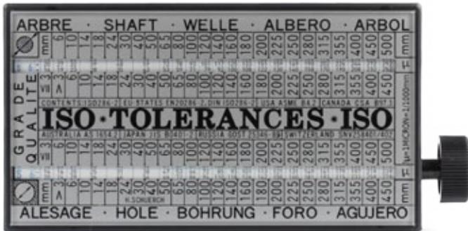
Der Tolerator zeigt alle Toleranzwerte nach ISO-Empfehlung R 286 - 1962 bis einschließlich Nennmaß 500 mm an.
