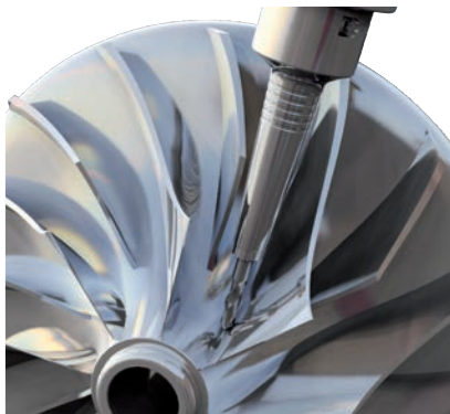
5-Achsbearbeitung mit Kugelfräser Finishing with ball endmill on 5-axis machine
