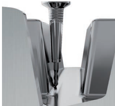
Schlichten mit Kugelfräser in engen Werkstückstellen Finishing with ball endmill in tight space
