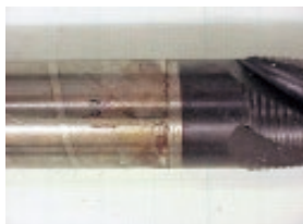
直柄的应力腐蚀
