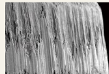
粗糙、有粒子脱落的磨损痕迹
