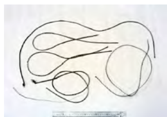
MS 断屑槽 (新型设计)
