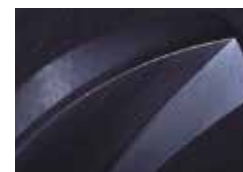
加工7小时后的刃尖状况 Cutting edge after 7 hours of milling
