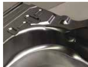
加工7小时后的刃尖状况 Cutting edge after 7 hours of milling
