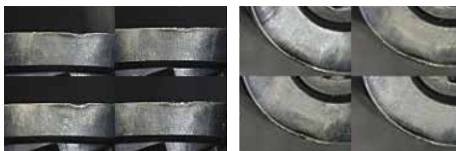
加工67.2m后的刀片照片 After 67.2m of milling
