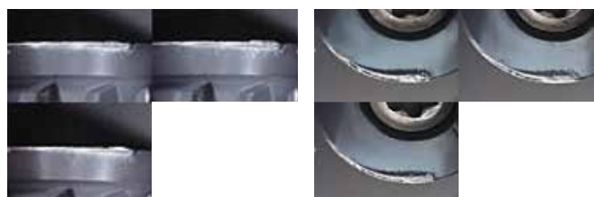
加工29m 后的刀片照片 After 29m of milling
