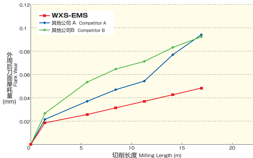
加工 16.8m 后的磨损情况 Tool wear after milling 16.8m
