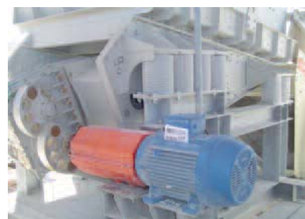
带偏心激振器的舱式卸料单元
