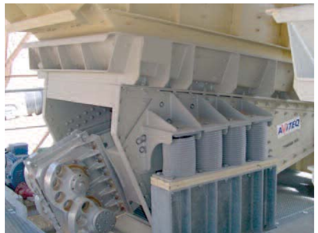
带防护套的压缩弹簧
