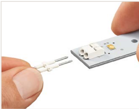
将跨接器插入PCB板上接线端子的进线孔中。
