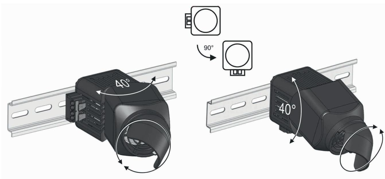
Durch die flexible Konstruktion lässt sich der Einbaulüfter punktgenau auf die Wärmequelle richten. Entstandene Wärmenester werden somit sehr schnell beseitigt bzw. werden bei rechtzeitigem Einsatz des Einbaulüfters vermieden. Bei vertikaler oder horizontaler Montage auf der DIN-Schiene lässt sich das Gelenk im Gehäuse um 40° in einer Achse bewegen. Die Luftführung an der vorderen Öffnung des Einbaulüfters wird um 45° umgelenkt und kann stufenlos um 360° gedreht werden.
