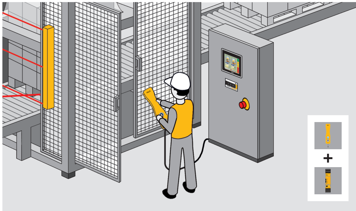
最佳解決方案：使用手動操作控制裝置 PITjog 和安全繼電器 PNOZ s6 進行雙手監控。
