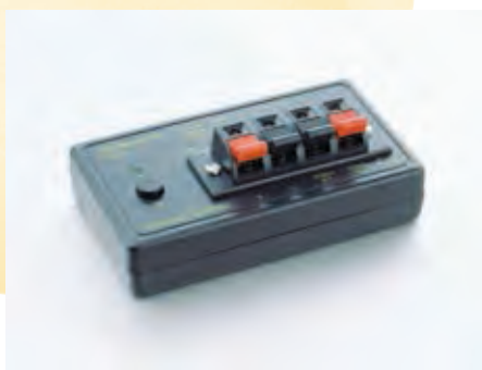
接近开关功能测试盒，可连接2, 3或4线接近开关或NAMUR开关。
