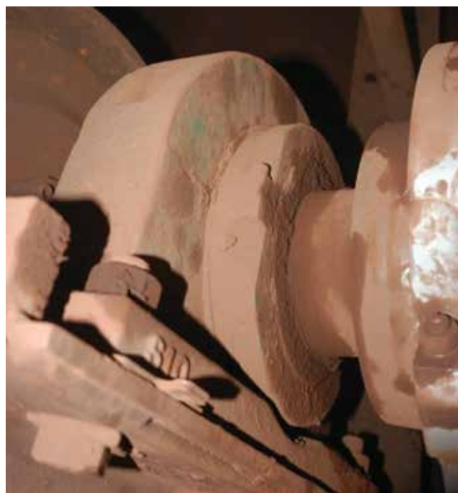
图 20. 图中所示的是钢铁行业应用场合中使用的 Timken 剖分式带座圆柱滚子轴承单元
