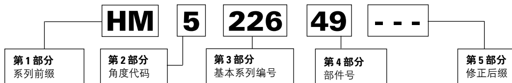
图 41. ABMA 英制部件编号系统示例。
