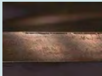
后角面 /后角面磨损量0.09mm
