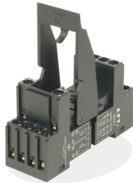
适用插座 (SKB14-E) 框式螺丝端子型、脱扣杆方式、宽度为27mm
